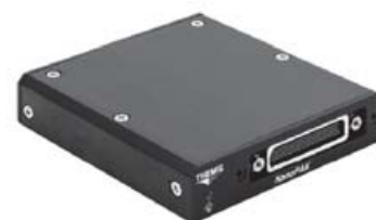
NanoPAK на базе Atom или AMD 21 x 89 x 96 мм (В x Ш x Г)
