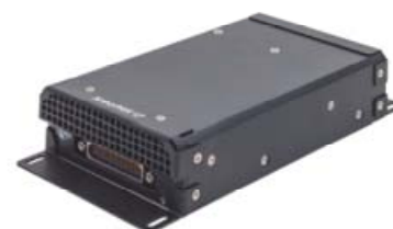
NanoPAK на базе I7 38 x 94 x 162 мм (В x Ш x Г)
